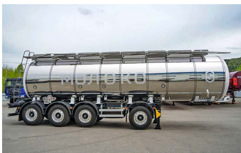
Молоковоз ППЦПТ 27КТ-42ЛЛ-4 с четырьмя отсеками объёмом 27 м 3 из нержавеющей стали AISI 304
