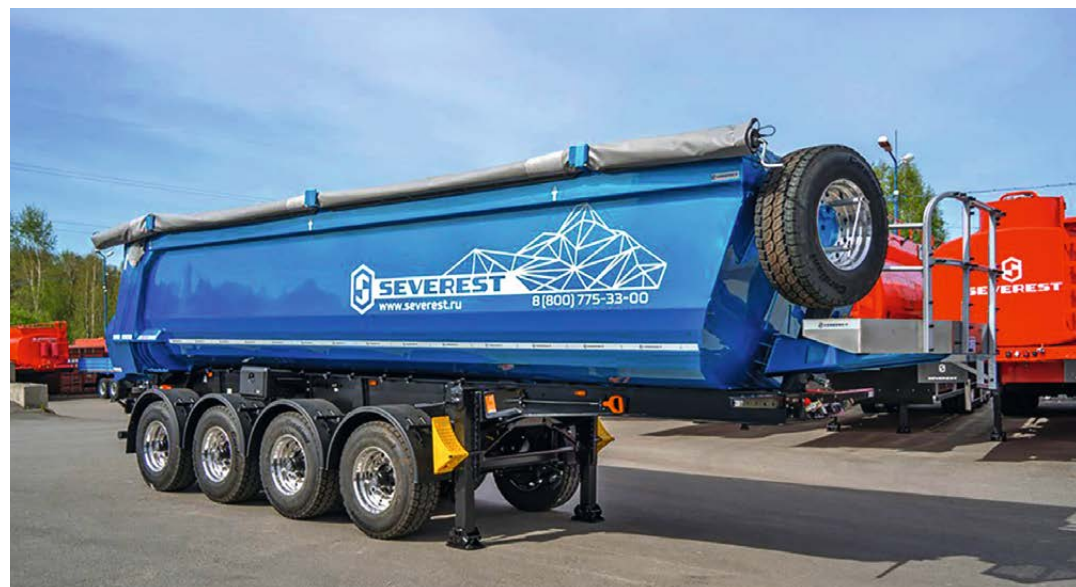
Самосвальный Severest объёмом 30 м 3 на четырёх осях под тягачи с высотой ССУ 1200 мм
