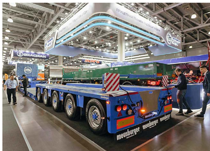
Восьмиосный трал Meusburger TP-8144 грузоподъемностью 120 тонн
