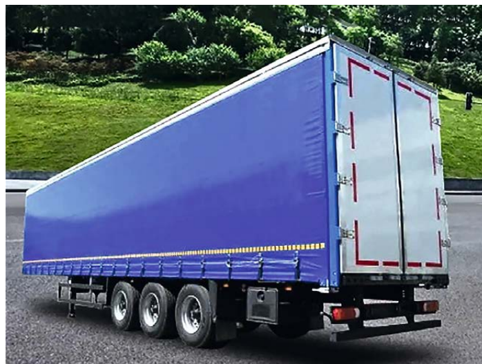
Шторный полуприцеп ТЗА 588 510-08 длиной 16,5 м вмещает 40 палет
