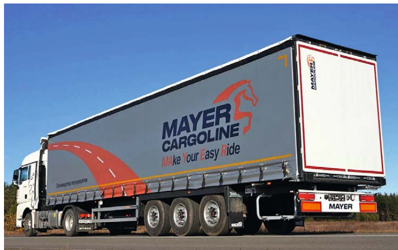
Удлиненный до 16,7 м трёхосный шторник Mayer Cargoline вмещает 41 палету
