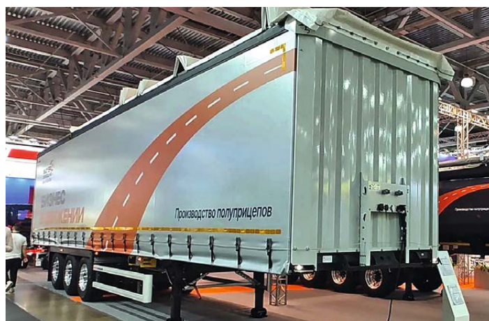
Удлиненный до 16,7 м трёхосный шторник Mayer Cargoline вмещает 41 палету
