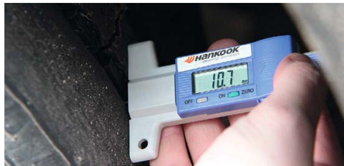
Замер остаточной глубины протектора специальным цифровым прибором
