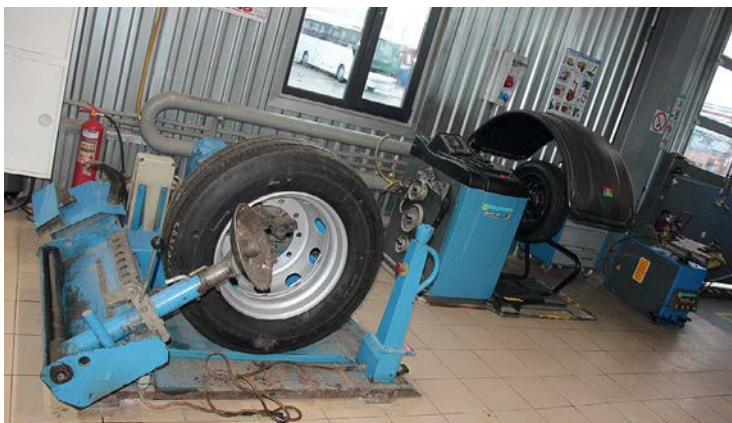
Шиномонтажный участок с балансировочным станком современного грузового технического центра
