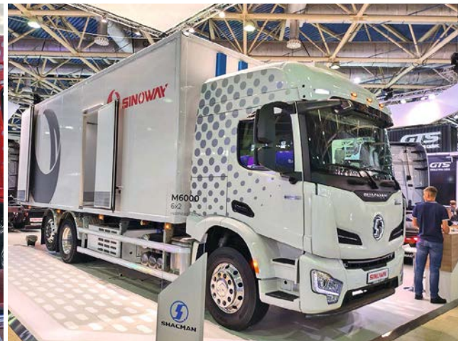
Рефрижератор M6000 с колёсной формулой 6x2 и возможностью боковой дозагрузки/разгрузки
